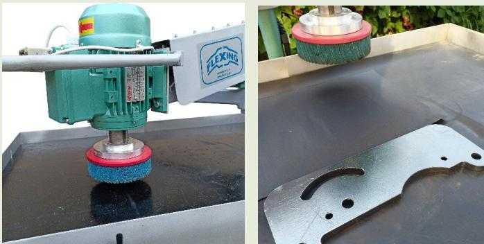
Glave za brušenje su namenjeni za brušenje, čišćenje, ravnih površina nakon glodanja, rezanja, bušenja, brušenja, brizganja, zavarivanja, itd., za odstranjivanje riseva, ivica, ispupčenja. Obrada se vrši na suvo.
